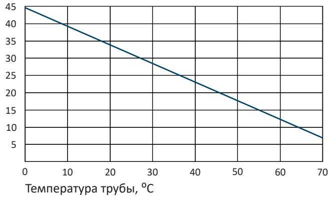
\* Для расчётов систем антиобледенения кровель данная таблица и график не применимы, и могут использоваться только в расчётах питающей сети систем обогрева трубопроводов и резервуаров.
